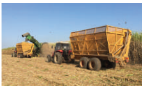
รถลำเลียงอ้อย (Haulout Bin) ทำงานรองอ้อยคู่กับรถตัด
